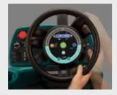
Controle por toque, Touch-n-Ġo™ com botão 1-Step™ aumente a segurança com controles intuitivos localizados na frente do operador, eliminando a necessidade de remover as mãos do volante para mudar as configurações da lavadora.
